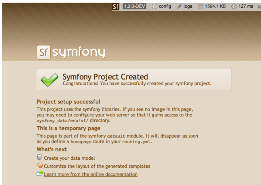
Figura 1.5. La barra de depuración web del entorno de desarrollo
